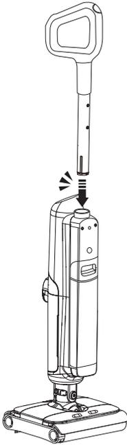
1.2 Desmontagem: Utilize um objeto duro tipo uma caneta para pressionar o trinco no interior do orifício situado na parte de trás da máquina e, ao mesmo tempo, puxe para cima a pega da unidade principal para a retirar.
